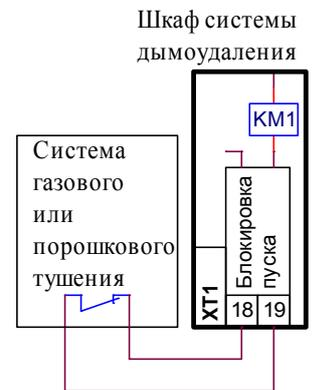
На рис. слева показан пример схемы блокировки шкафа управления вентилятором общеобменной вентиляции при включении вентилятора противодымной вентиляции.
